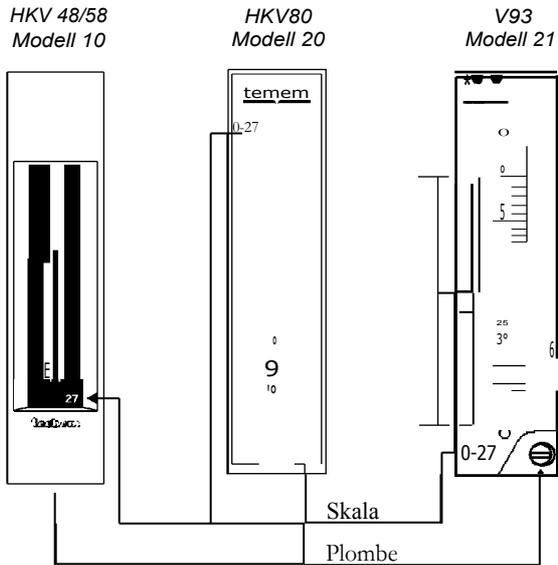
Zum Ausgleich der Kaltverdunstung während der heizfreien Periode sind die Ampullen beim Einbau um 5,3 mm überfüllt. Darum kann bei der Zwischenablesung der Flüssigkeitsstand über Null stehen.
